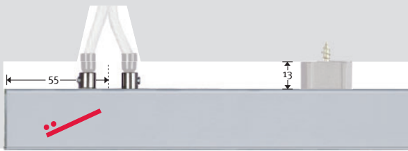
Einbauschiene mit Einspeisung rechts oder links Recessed track with power feed right or left
